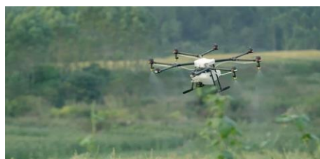
شکل ۲ - پهپاد DJI MG-1 برای سمپاشی زمین کشاورزی
